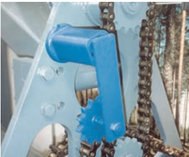
Kettenspanner an Papierrollmechanismus
