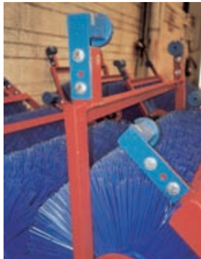
Lagerung Reinigungsbürste an Kartoffelernter
