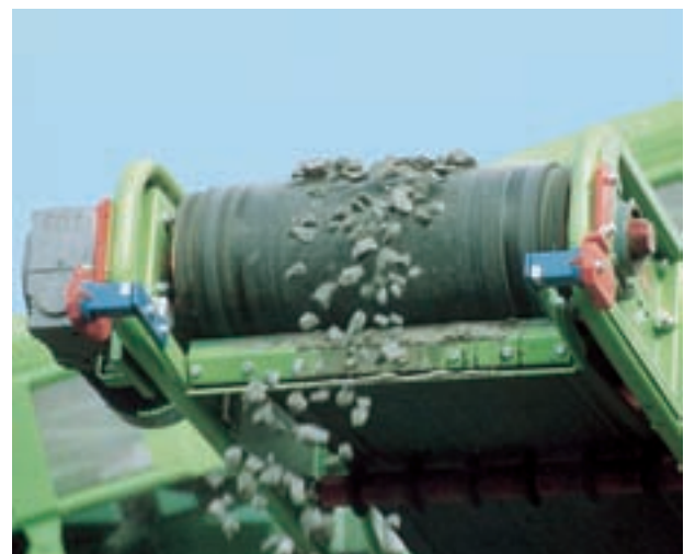
Elastische Lagerung von Bandabstreifer
