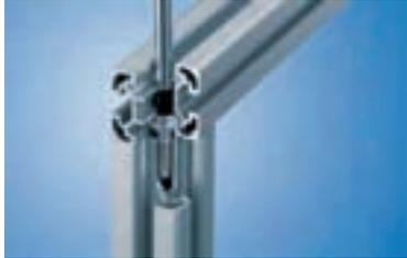
Die starken Kernzüge in den Profilen ermöglichen ein einfaches Gewindeschneiden (bis M16) oder den Einsatz von selbstformenden Schrauben.
